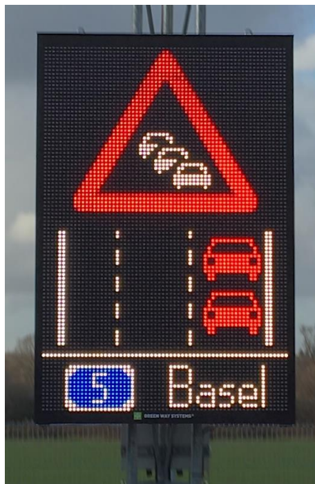
Abbildung: Anzeigestandort in LED-RGB-Technik (Quelle: Green Way Systems GmbH)
